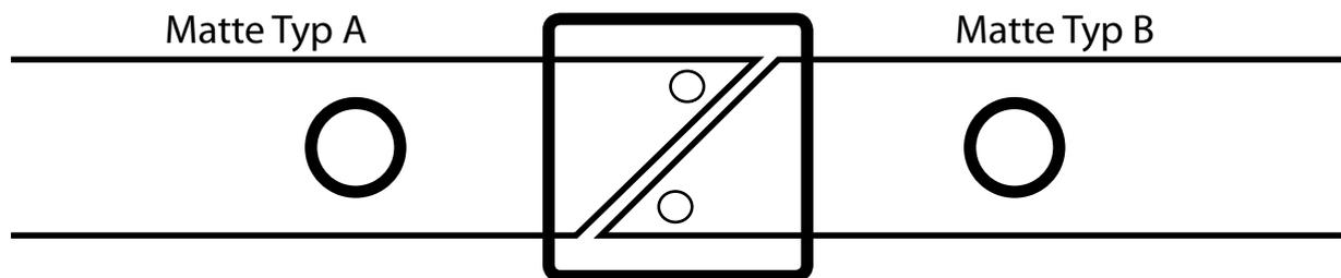
Im normalen Zaunverlauf müssen Matten von Typ A und Typ B im Wechsel gesetzt werden.
